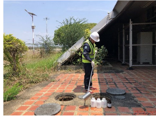
บ่อกักน้ำทิ้งก่อนผ่านระบบบำบัดน้ำเสียอาคารที่พักผู้โดยสาร
